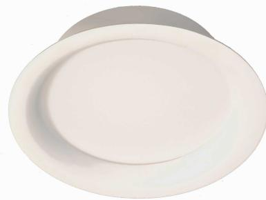
Luminária circular de embutir em forro de gesso, 24W 3000K IRC>80. Corpo em alumínio. Acabamento Preta. Controle óptico principal através de difusor em poliestireno translúcido. Luminária grau de proteção IP-20. Driver corrente constante Liga/Desliga, Triac, 1-10V ou Dali (consultar condições). Tensão de trabalho 220V ou Bivolt.
