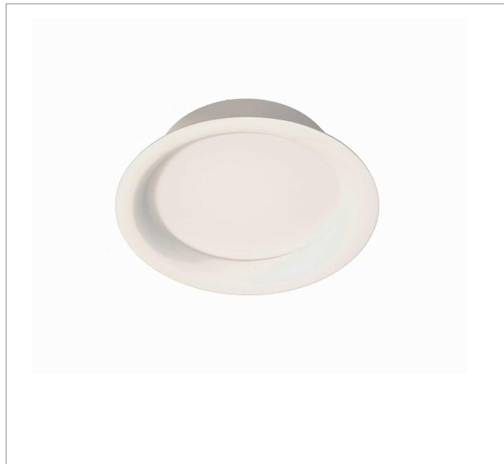
Luminária circular de embutir em forro de gesso, 24W 4000K IRC>80. Corpo em alumínio. Acabamento Preta. Controle óptico principal através de difusor em poliestireno translúcido. Luminária grau de proteção IP-20. Driver corrente constante Liga/Desliga, Triac, 1-10V ou Dali (consultar condições). Tensão de trabalho 220V ou Bivolt.
