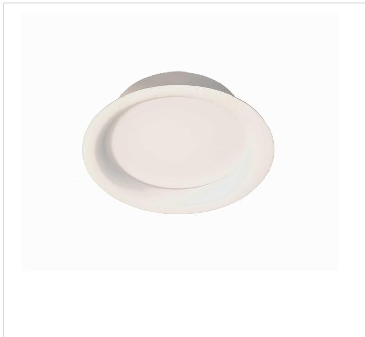
Luminária circular de embutir em forro de gesso, 24W 5000K IRC>80. Corpo em alumínio. Acabamento Preta. Controle óptico principal através de difusor em poliestireno translúcido. Luminária grau de proteção IP-20. Driver corrente constante Liga/Desliga, Triac, 1-10V ou Dali (consultar condições). Tensão de trabalho 220V ou Bivolt.
