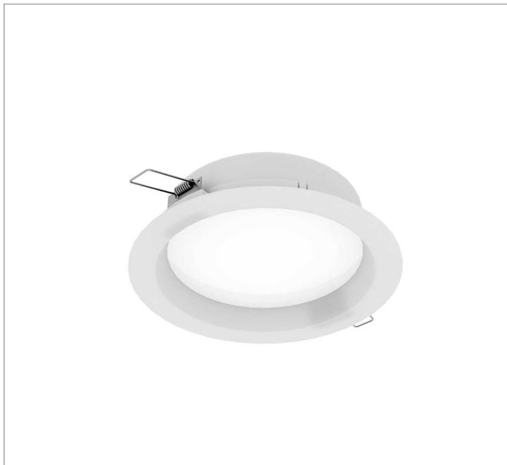
Luminária circular de embutir em forro de gesso, 14W 2700K IRC>80. Corpo em alumínio. Acabamento branco, preto ou especial. Controle óptico principal através de difusor em acrílico translúcido. Luminária grau de proteção IP-20. Driver corrente constante Liga/Desliga, Triac, 1-10V ou Dali (consultar condições). Tensão de trabalho 220V ou Bivolt.
