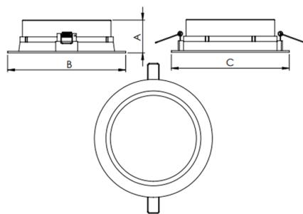
Luminária circular de embutir em forro de gesso, 14W 4000K IRC>80. Corpo em alumínio. Acabamento branco, preto ou especial. Controle óptico principal através de difusor em acrílico translúcido. Luminária grau de proteção IP-20. Driver corrente constante Liga/Desliga, Triac, 1-10V ou Dali (consultar condições). Tensão de trabalho 220V ou Bivolt.
