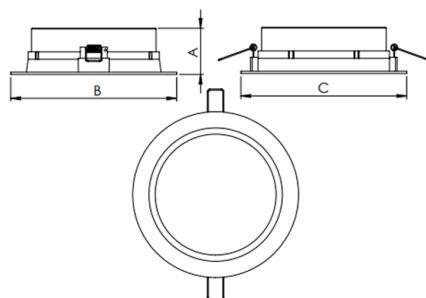
Luminária circular de embutir em forro de gesso, 20W 5000K IRC>80. Corpo em alumínio. Acabamento branco, preto ou especial. Controle óptico principal através de difusor em acrílico translúcido. Luminária grau de proteção IP-20. Driver corrente constante Liga/Desliga, Triac, 1-10V ou Dali (consultar condições). Tensão de trabalho 220V ou Bivolt.
