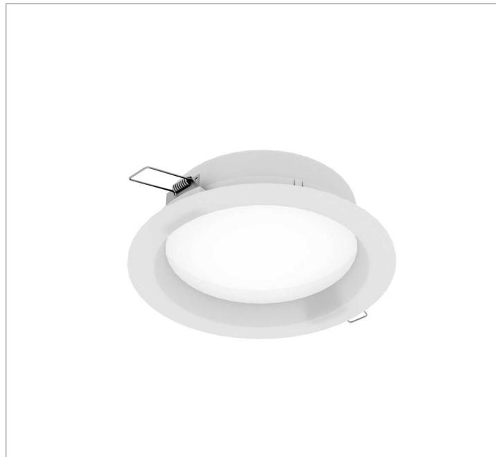
Luminária circular de embutir em forro de gesso, 7W 3000K IRC>80. Corpo em alumínio. Acabamento branco, preto ou especial. Controle óptico principal através de difusor em acrílico translúcido. Luminária grau de proteção IP-20. Driver corrente constante Liga/Desliga, Triac, 1-10V ou Dali (consultar condições). Tensão de trabalho 220V ou Bivolt.
