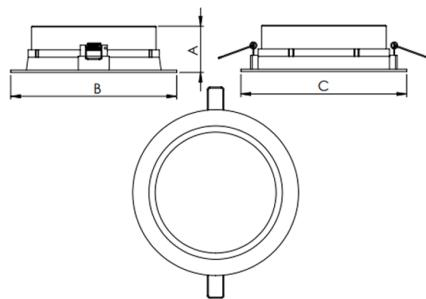
Luminária circular de embutir em forro de gesso, 7W 2700K IRC>80. Corpo em alumínio. Acabamento branco, preto ou especial. Controle óptico principal através de difusor em poliestireno translúcido. Luminária grau de proteção IP-20. Driver corrente constante Liga/Desliga, Triac, 1-10V ou Dali (consultar condições). Tensão de trabalho 220V ou Bivolt.
