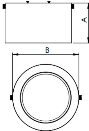
Luminária circular de sobrepor, 10W 5000K IRC>80. Corpo em alumínio. Acabamento branco, preto ou especial. Controle óptico principal através de difusor em acrílico translúcido. Luminária grau de proteção IP-20. Driver corrente constante Liga/Desliga, Triac, 1-10V ou Dali (consultar condições). Tensão de trabalho 220V ou Bivolt.
