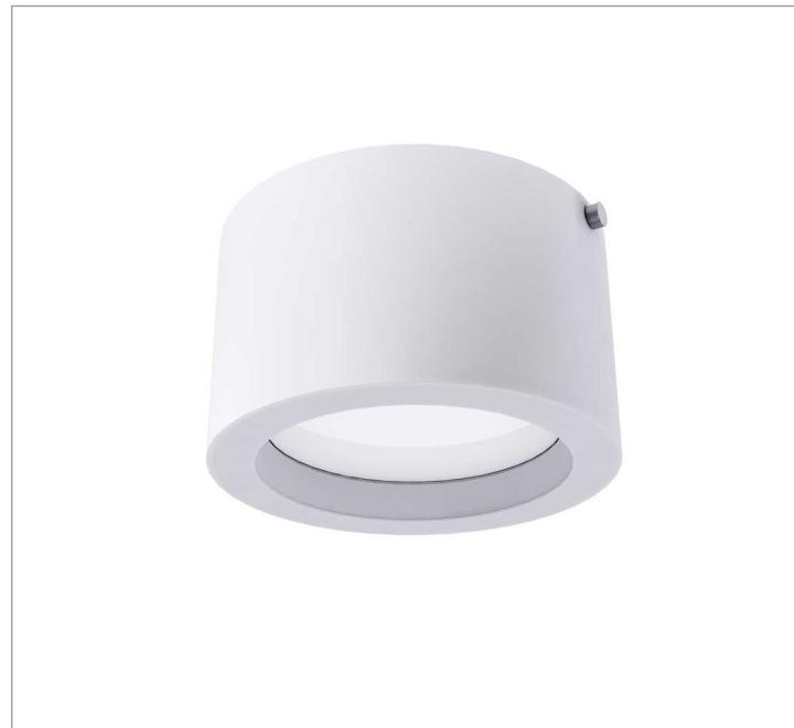
Luminária circular de sobrepor, 14W 5000K IRC>80. Corpo em alumínio. Acabamento branco, preto ou especial. Controle óptico principal através de difusor em acrílico translúcido. Luminária grau de proteção IP-20. Driver corrente constante Liga/Desliga, Triac, 1-10V ou Dali (consultar condições). Tensão de trabalho 220V ou Bivolt.
