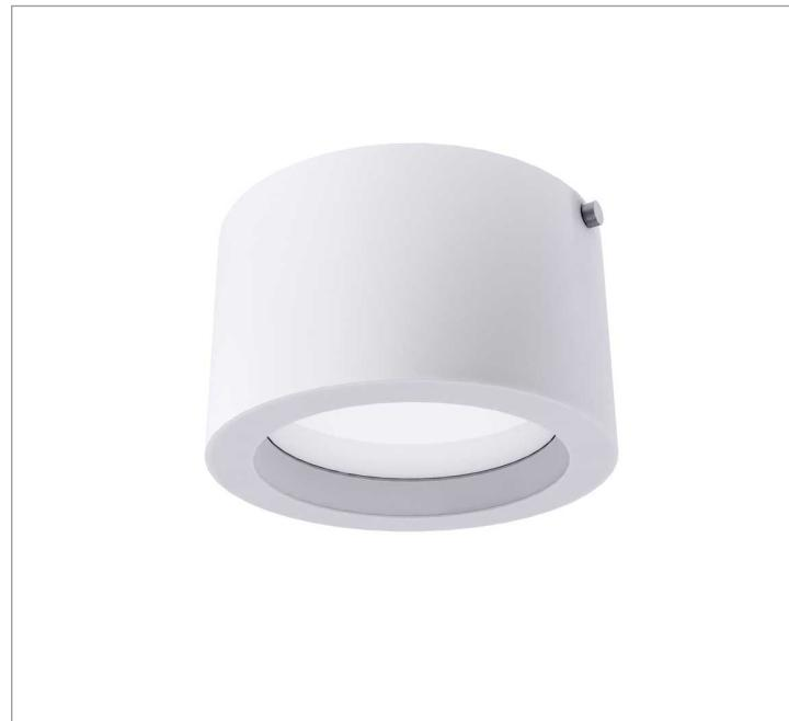
Luminária circular de sobrepor, 20W 3000K IRC>80. Corpo em alumínio. Acabamento branco, preto ou especial. Controle óptico principal através de difusor em acrílico translúcido. Luminária grau de proteção IP-20. Driver corrente constante Liga/Desliga, Triac, 1-10V ou Dali (consultar condições). Tensão de trabalho 220V ou Bivolt.
