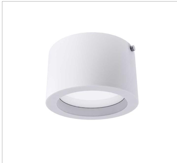
Luminária circular de sobrepor, 28W 2700K IRC>80. Corpo em alumínio. Acabamento branco, preto ou especial. Controle óptico principal através de difusor em acrílico translúcido. Luminária grau de proteção IP-20. Driver corrente constante Liga/Desliga, Triac, 1-10V ou Dali (consultar condições). Tensão de trabalho 220V ou Bivolt.
