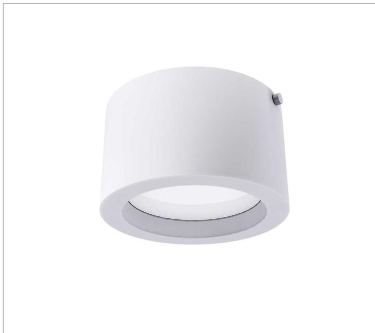
Luminária circular de sobrepor, 28W 4000K IRC>80. Corpo em alumínio. Acabamento Branca, Preta ou Especial. Controle óptico principal através de difusor em acrílico translúcido. Luminária grau de proteção IP-20. Driver corrente constante Liga/Desliga, Triac, 1-10V ou Dali (consultar condições). Tensão de trabalho 220V ou Bivolt.
