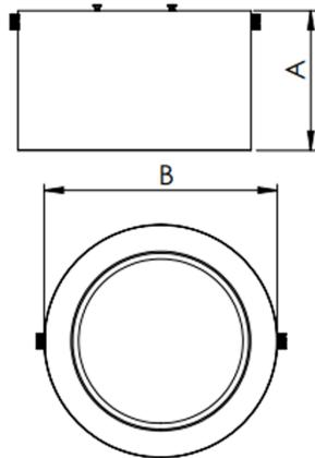
Luminária circular de sobrepor, 28W 5000K IRC>80. Corpo em alumínio. Acabamento branco, preto ou especial. Controle óptico principal através de difusor em acrílico translúcido. Luminária grau de proteção IP-20. Driver corrente constante Liga/Desliga, Triac, 1-10V ou Dali (consultar condições). Tensão de trabalho 220V ou Bivolt.
