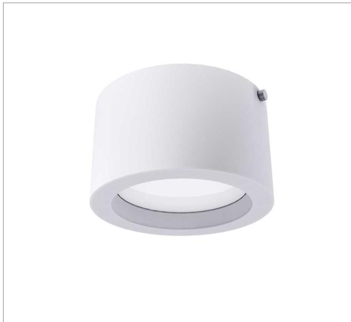
Luminária circular de sobrepor, 7W 2700K IRC>80. Corpo em alumínio. Acabamento branco, preto ou especial. Controle óptico principal através de difusor em acrílico translúcido. Luminária grau de proteção IP-20. Driver corrente constante Liga/Desliga, Triac, 1-10V ou Dali (consultar condições). Tensão de trabalho 220V ou Bivolt.
