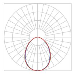
Luminária circular de sobrepor, 7W 5000K IRC>80. Corpo em alumínio. Acabamento branco, preto ou especial. Controle óptico principal através de difusor em acrílico translúcido. Luminária grau de proteção IP-20. Driver corrente constante Liga/Desliga, Triac, 1-10V ou Dali (consultar condições). Tensão de trabalho 220V ou Bivolt.
