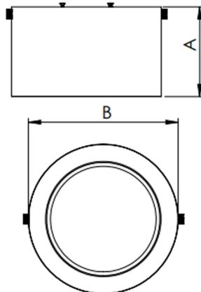
Luminária circular de sobrepor, 7W 5000K IRC>80. Corpo em alumínio. Acabamento branco, preto ou especial. Controle óptico principal através de difusor em acrílico translúcido. Luminária grau de proteção IP-20. Driver corrente constante Liga/Desliga, Triac, 1-10V ou Dali (consultar condições). Tensão de trabalho 220V ou Bivolt.
