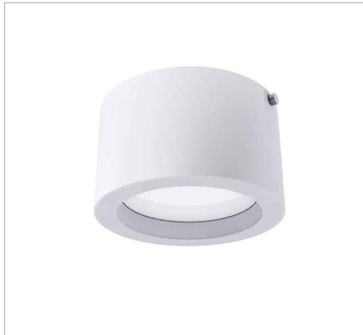
Luminária circular de sobrepor, 10W 2700K IRC>80. Corpo em alumínio. Acabamento branco, preto ou especial. Controle óptico principal através de difusor em poliestireno translúcido. Luminária grau de proteção IP-20. Driver corrente constante Liga/Desliga, Triac, 1-10V ou Dali (consultar condições). Tensão de trabalho 220V ou Bivolt.
