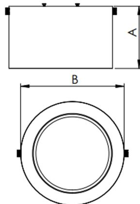
Luminária circular de sobrepor, 10W 4000K IRC>80. Corpo em alumínio. Acabamento branco, preto ou especial. Controle óptico principal através de difusor em poliestireno translúcido. Luminária grau de proteção IP-20. Driver corrente constante Liga/Desliga, Triac, 1-10V ou Dali (consultar condições). Tensão de trabalho 220V ou Bivolt.
