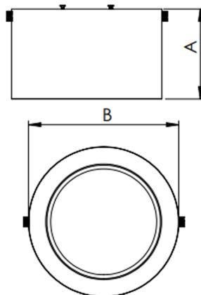
Luminária circular de sobrepor, 14W 2700K IRC>80. Corpo em alumínio. Acabamento branco, preto ou especial. Controle óptico principal através de difusor em poliestireno translúcido. Luminária grau de proteção IP-20. Driver corrente constante Liga/Desliga, Triac, 1-10V ou Dali (consultar condições). Tensão de trabalho 220V ou Bivolt.
