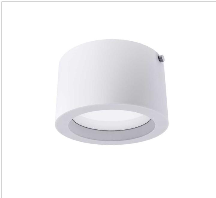
Luminária circular de sobrepor, 14W 4000K IRC>80. Corpo em alumínio. Acabamento branco, preto ou especial. Controle óptico principal através de difusor em poliestireno translúcido. Luminária grau de proteção IP-20. Driver corrente constante Liga/Desliga, Triac, 1-10V ou Dali (consultar condições). Tensão de trabalho 220V ou Bivolt.
