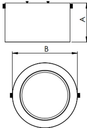
Luminária circular de sobrepor, 28W 2700K IRC>80. Corpo em alumínio. Acabamento branco, preto ou especial. Controle óptico principal através de difusor em poliestireno translúcido. Luminária grau de proteção IP-20. Driver corrente constante Liga/Desliga, Triac, 1-10V ou Dali (consultar condições). Tensão de trabalho 220V ou Bivolt.
