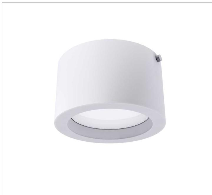
Luminária circular de sobrepor, 28W 3000K IRC>80. Corpo em alumínio. Acabamento branco, preto ou especial. Controle óptico principal através de difusor em poliestireno translúcido. Luminária grau de proteção IP-20. Driver corrente constante Liga/Desliga, Triac, 1-10V ou Dali (consultar condições). Tensão de trabalho 220V ou Bivolt.
