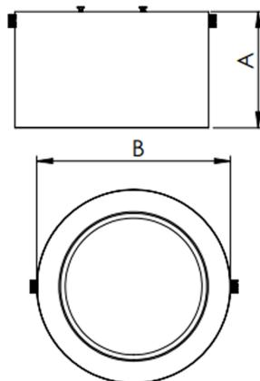
Luminária circular de sobrepor, 37W 3000K IRC>80. Corpo em alumínio. Acabamento branco, preto ou especial. Controle óptico principal através de difusor em poliestireno translúcido. Luminária grau de proteção IP-20. Driver corrente constante Liga/Desliga, Triac, 1-10V ou Dali (consultar condições). Tensão de trabalho 220V ou Bivolt.
