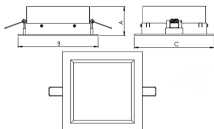
Luminária quadrada de embutir em forro de gesso, 10W 2700K IRC>80. Corpo em alumínio. Acabamento branco, preto ou especial. Controle óptico principal através de difusor em acrílico translúcido. Luminária grau de proteção IP-20. Driver corrente constante Liga/Desliga, Triac, 1-10V ou Dali (consultar condições). Tensão de trabalho 220V ou Bivolt.
