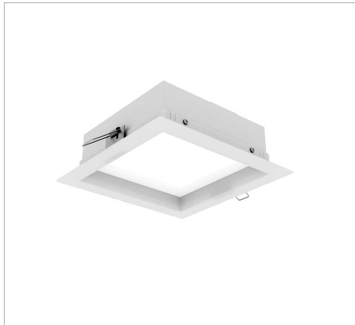
Luminária quadrada de embutir em forro de gesso, 14W 3000K IRC>80. Corpo em alumínio. Acabamento branco, preto ou especial. Controle óptico principal através de difusor em acrílico translúcido. Luminária grau de proteção IP-20. Driver corrente constante Liga/Desliga, Triac, 1-10V ou Dali (consultar condições). Tensão de trabalho 220V ou Bivolt.
