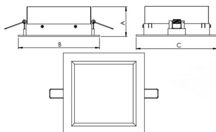
Luminária quadrada de embutir em forro de gesso, 14W 4000K IRC>80. Corpo em alumínio. Acabamento branco, preto ou especial. Controle óptico principal através de difusor em acrílico translúcido. Luminária grau de proteção IP-20. Driver corrente constante Liga/Desliga, Triac, 1-10V ou Dali (consultar condições). Tensão de trabalho 220V ou Bivolt.
