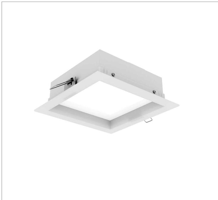
Luminária quadrada de embutir em forro de gesso, 20W 2700K IRC>80. Corpo em alumínio. Acabamento branco, preto ou especial. Controle óptico principal através de difusor em acrílico translúcido. Luminária grau de proteção IP-20. Driver corrente constante Liga/Desliga, Triac, 1-10V ou Dali (consultar condições). Tensão de trabalho 220V ou Bivolt.
