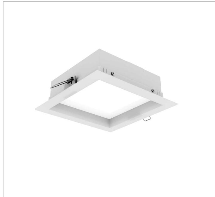
Luminária quadrada de embutir em forro de gesso, 20W 3000K IRC>80. Corpo em alumínio. Acabamento branco, preto ou especial. Controle óptico principal através de difusor em acrílico translúcido. Luminária grau de proteção IP-20. Driver corrente constante Liga/Desliga, Triac, 1-10V ou Dali (consultar condições). Tensão de trabalho 220V ou Bivolt.
