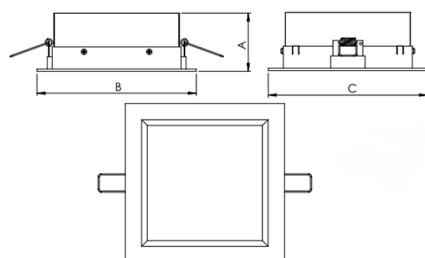
Luminária quadrada de embutir em forro de gesso, 20W 4000K IRC>80. Corpo em alumínio. Acabamento branco, preto ou especial. Controle óptico principal através de difusor em acrílico translúcido. Luminária grau de proteção IP-20. Driver corrente constante Liga/Desliga, Triac, 1-10V ou Dali (consultar condições). Tensão de trabalho 220V ou Bivolt.
