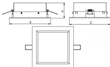
Luminária quadrada de embutir em forro de gesso, 28W 2700K IRC>80. Corpo em alumínio. Acabamento branco, preto ou especial. Controle óptico principal através de difusor em acrílico translúcido. Luminária grau de proteção IP-20. Driver corrente constante Liga/Desliga, Triac, 1-10V ou Dali (consultar condições). Tensão de trabalho 220V ou Bivolt.
