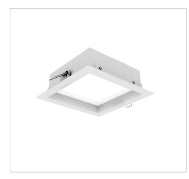
Luminária quadrada de embutir em forro de gesso, 28W 3000K IRC>80. Corpo em alumínio. Acabamento branco, preto ou especial. Controle óptico principal através de difusor em acrílico translúcido. Luminária grau de proteção IP-20. Driver corrente constante Liga/Desliga, Triac, 1-10V ou Dali (consultar condições). Tensão de trabalho 220V ou Bivolt.
