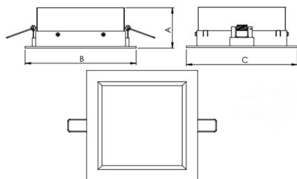
Luminária quadrada de embutir em forro de gesso, 28W 4000K IRC>80. Corpo em alumínio. Acabamento branco, preto ou especial. Controle óptico principal através de difusor em acrílico translúcido. Luminária grau de proteção IP-20. Driver corrente constante Liga/Desliga, Triac, 1-10V ou Dali (consultar condições). Tensão de trabalho 220V ou Bivolt.
