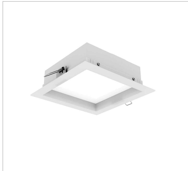
Luminária quadrada de embutir em forro de gesso, 28W 5000K IRC>80. Corpo em alumínio. Acabamento branco, preto ou especial. Controle óptico principal através de difusor em acrílico translúcido. Luminária grau de proteção IP-20. Driver corrente constante Liga/Desliga, Triac, 1-10V ou Dali (consultar condições). Tensão de trabalho 220V ou Bivolt.
