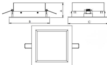
Luminária quadrada de embutir em forro de gesso, 7W 2700K IRC>80. Corpo em alumínio. Acabamento branco, preto ou especial. Controle óptico principal através de difusor em acrílico translúcido. Luminária grau de proteção IP-20. Driver corrente constante Liga/Desliga, Triac, 1-10V ou Dali (consultar condições). Tensão de trabalho 220V ou Bivolt.
