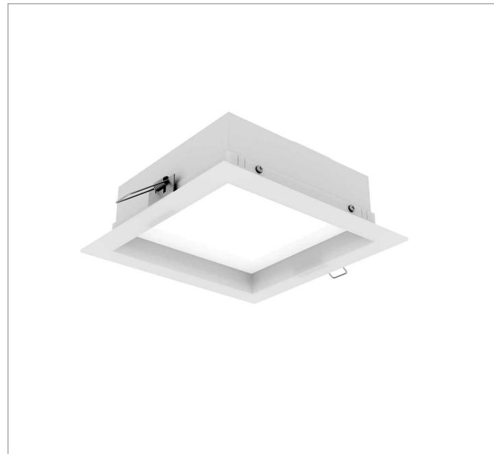
Luminária quadrada de embutir em forro de gesso, 7W 3000K IRC>80. Corpo em alumínio. Acabamento branco, preto ou especial. Controle óptico principal através de difusor em acrílico translúcido. Luminária grau de proteção IP-20. Driver corrente constante Liga/Desliga, Triac, 1-10V ou Dali (consultar condições). Tensão de trabalho 220V ou Bivolt.
