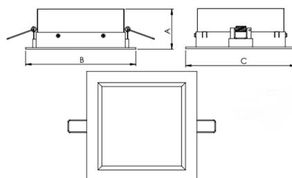
Luminária quadrada de embutir em forro de gesso, 7W 3000K IRC>80. Corpo em alumínio. Acabamento branco, preto ou especial. Controle óptico principal através de difusor em acrílico translúcido. Luminária grau de proteção IP-20. Driver corrente constante Liga/Desliga, Triac, 1-10V ou Dali (consultar condições). Tensão de trabalho 220V ou Bivolt.
