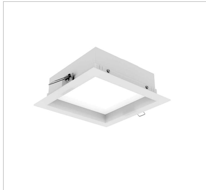
Luminária quadrada de embutir em forro de gesso, 7W 5000K IRC>80. Corpo em alumínio. Acabamento branco, preto ou especial. Controle óptico principal através de difusor em acrílico translúcido. Luminária grau de proteção IP-20. Driver corrente constante Liga/Desliga, Triac, 1-10V ou Dali (consultar condições). Tensão de trabalho 220V ou Bivolt.
