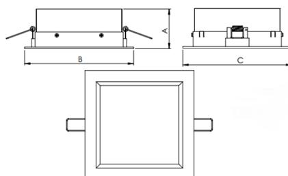
Luminária quadrada de embutir em forro de gesso, 14W 3000K IRC>80. Corpo em alumínio. Acabamento branco, preto ou especial. Controle óptico principal através de difusor em poliestireno translúcido. Luminária grau de proteção IP-20. Driver corrente constante Liga/Desliga, Triac, 1-10V ou Dali (consultar condições). Tensão de trabalho 220V ou Bivolt.
