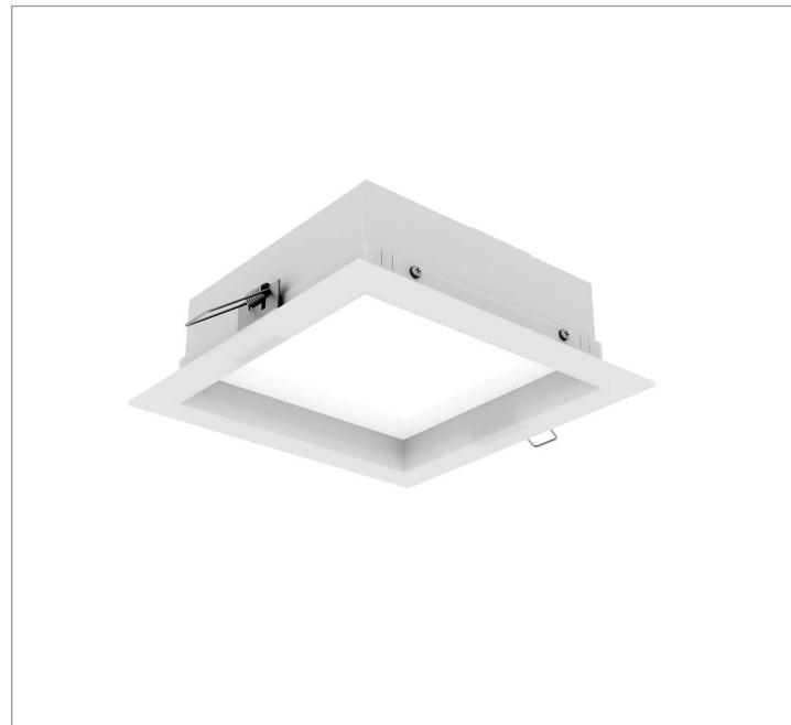
Luminária quadrada de embutir em forro de gesso, 20W 5000K IRC>80. Corpo em alumínio. Acabamento branco, preto ou especial. Controle óptico principal através de difusor em poliestireno translúcido. Luminária grau de proteção IP-20. Driver corrente constante Liga/Desliga, Triac, 1-10V ou Dali (consultar condições). Tensão de trabalho 220V ou Bivolt.
