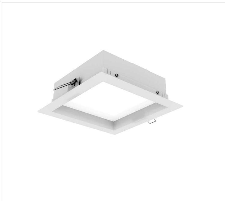
Luminária quadrada de embutir em forro de gesso, 37W 3000K IRC>80. Corpo em alumínio. Acabamento Branca, Preta ou Especial. Controle óptico principal através de difusor em poliestireno translúcido. Luminária grau de proteção IP-20. Driver corrente constante Liga/Desliga, Triac, 1-10V ou Dali (consultar condições). Tensão de trabalho 220V ou Bivolt.
