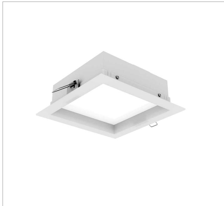
Luminária quadrada de embutir em forro de gesso, 37W 4000K IRC>80. Corpo em alumínio. Acabamento branco, preto ou especial. Controle óptico principal através de difusor em poliestireno translúcido. Luminária grau de proteção IP-20. Driver corrente constante Liga/Desliga, Triac, 1-10V ou Dali (consultar condições). Tensão de trabalho 220V ou Bivolt.
