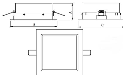
Luminária quadrada de embutir em forro de gesso, 7W 5000K IRC>80. Corpo em alumínio. Acabamento branco, preto ou especial. Controle óptico principal através de difusor em poliestireno translúcido. Luminária grau de proteção IP-20. Driver corrente constante Liga/Desliga, Triac, 1-10V ou Dali (consultar condições). Tensão de trabalho 220V ou Bivolt.
