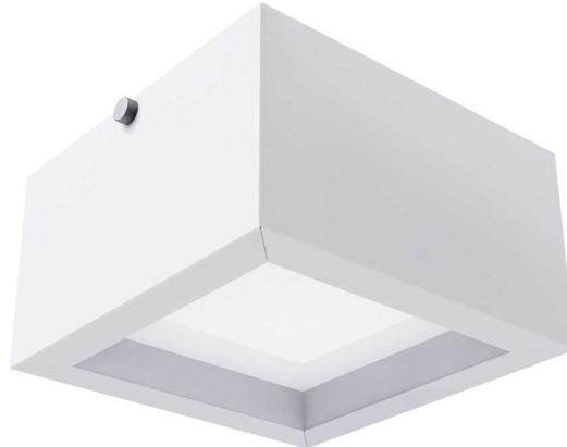
Luminária quadrada de sobrepor, 14W 2700K IRC>80. Corpo em alumínio. Acabamento branco, preto ou especial. Controle óptico principal através de difusor em acrílico translúcido. Luminária grau de proteção IP-20. Driver corrente constante Liga/Desliga, Triac, 1-10V ou Dali (consultar condições). Tensão de trabalho 220V ou Bivolt.
