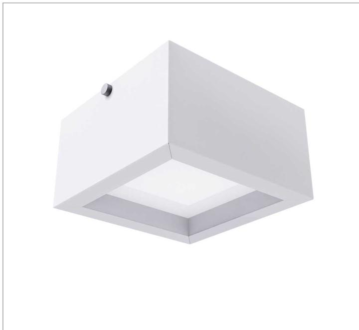
Luminária quadrada de sobrepor, 14W 3000K IRC>80. Corpo em alumínio. Acabamento branco, preto ou especial. Controle óptico principal através de difusor em acrílico translúcido. Luminária grau de proteção IP-20. Driver corrente constante Liga/Desliga, Triac, 1-10V ou Dali (consultar condições). Tensão de trabalho 220V ou Bivolt.
