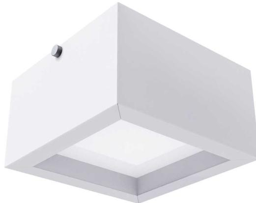
Luminária quadrada de sobrepor, 20W 2700K IRC>80. Corpo em alumínio. Acabamento branco, preto ou especial. Controle óptico principal através de difusor em acrílico translúcido. Luminária grau de proteção IP-20. Driver corrente constante Liga/Desliga, Triac, 1-10V ou Dali (consultar condições). Tensão de trabalho 220V ou Bivolt.
