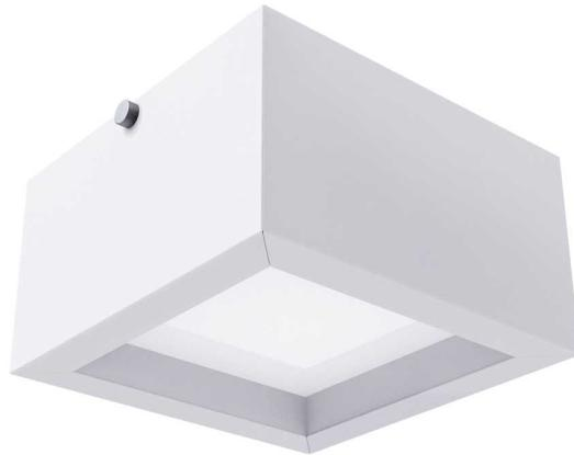
Luminária quadrada de sobrepor, 20W 4000K IRC>80. Corpo em alumínio. Acabamento branco, preto ou especial. Controle óptico principal através de difusor em acrílico translúcido. Luminária grau de proteção IP-20. Driver corrente constante Liga/Desliga, Triac, 1-10V ou Dali (consultar condições). Tensão de trabalho 220V ou Bivolt.
