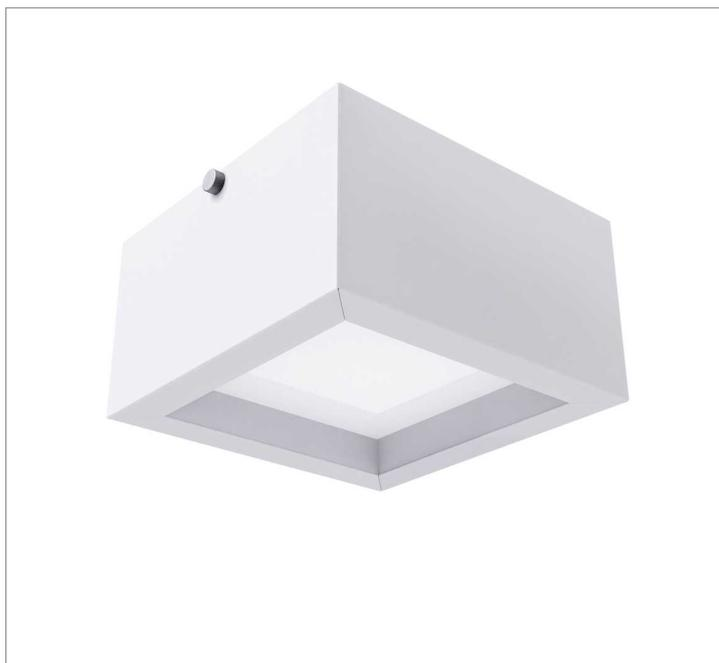
Luminária quadrada de sobrepor, 28W 3000K IRC>80. Corpo em alumínio. Acabamento branco, preto ou especial. Controle óptico principal através de difusor em acrílico translúcido. Luminária grau de proteção IP-20. Driver corrente constante Liga/Desliga, Triac, 1-10V ou Dali (consultar condições). Tensão de trabalho 220V ou Bivolt.
