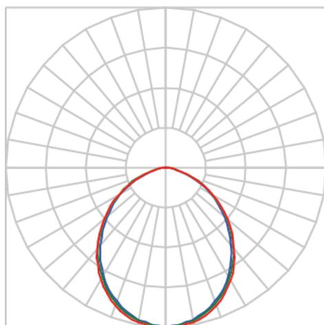
Luminária quadrada de sobrepor, 28W 5000K IRC>80. Corpo em alumínio. Acabamento Branca, Preta ou Especial. Controle óptico principal através de difusor em acrílico translúcido. Luminária grau de proteção IP-20. Driver corrente constante Liga/Desliga, Triac, 1-10V ou Dali (consultar condições). Tensão de trabalho 220V ou Bivolt.
