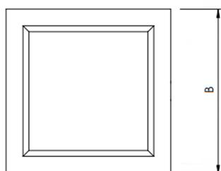
Luminária quadrada de sobrepor, 7W 2700K IRC>80. Corpo em alumínio. Acabamento branco, preto ou especial. Controle óptico principal através de difusor em acrílico translúcido. Luminária grau de proteção IP-20. Driver corrente constante Liga/Desliga, Triac, 1-10V ou Dali (consultar condições). Tensão de trabalho 220V ou Bivolt.
