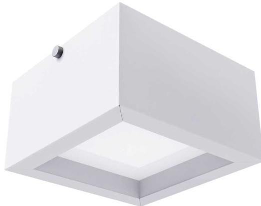
Luminária quadrada de sobrepor, 7W 3000K IRC>80. Corpo em alumínio. Acabamento branco, preto ou especial. Controle óptico principal através de difusor em acrílico translúcido. Luminária grau de proteção IP-20. Driver corrente constante Liga/Desliga, Triac, 1-10V ou Dali (consultar condições). Tensão de trabalho 220V ou Bivolt.
