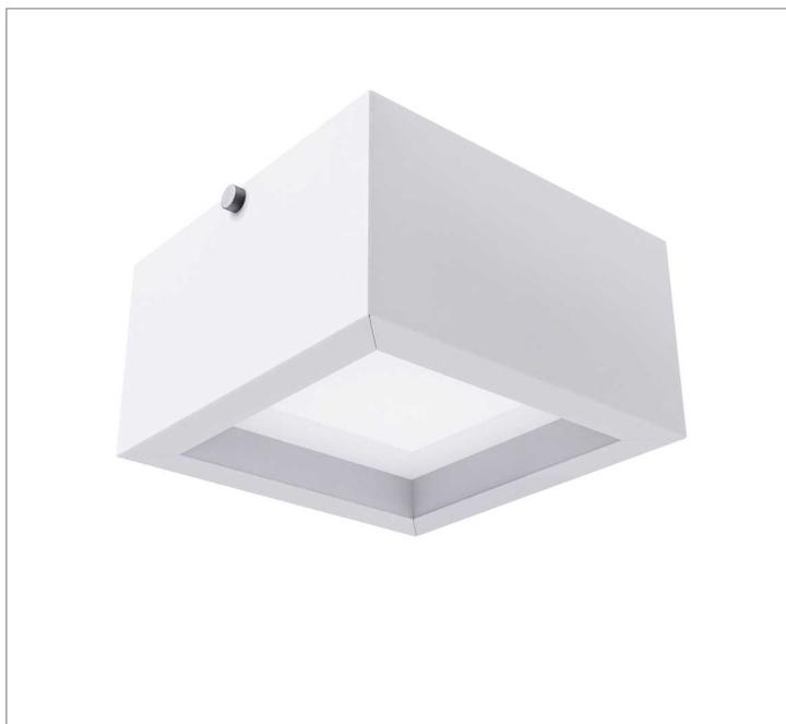
Luminária quadrada de sobrepor, 28W 2700K IRC>80. Corpo em alumínio. Acabamento branco, preto ou especial. Controle óptico principal através de difusor em poliestireno translúcido. Luminária grau de proteção IP-20. Driver corrente constante Liga/Desliga, Triac, 1-10V ou Dali (consultar condições). Tensão de trabalho 220V ou Bivolt.
